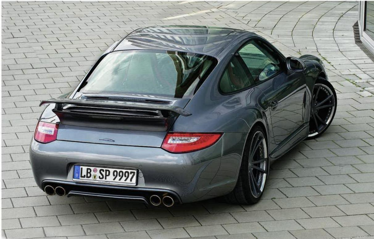
все более цепкими и все более... комфортными. В speedART для своего автомобиля подобрали комплект пружин от H&R. Но даже в сочетании с 20-дюймовыми колесами и низкопрофильными шинами размерности 235/30 спереди и 305/25 сзади 911-й удивлял своей весьма достойной плавностью хода. Во всяком случае, в пригородах Штутгарта, где порой попадаются участки с отнюдь неидеальным покрытием. Своим же
