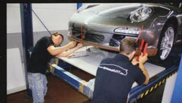
Hauseigener Modellbau: Im Bild entsteht eine Frontspoiler-Lippe für den 997 Carrera Mk2
