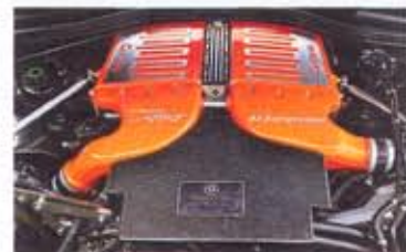
Im BMW-Maschinenraum bringt G-Power tatsächlich zwei Kompressoren und deren Peripherie unter
