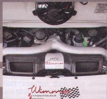
**Pure Performance:** Wimmer hat die Verdichterräder der VTG-Lader modifiziert. Damit erhöht er die Leistung von 530 auf 650 PS
