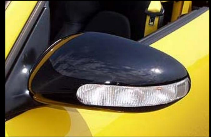
Rückspiegelschalen mit integriertem Blinker
