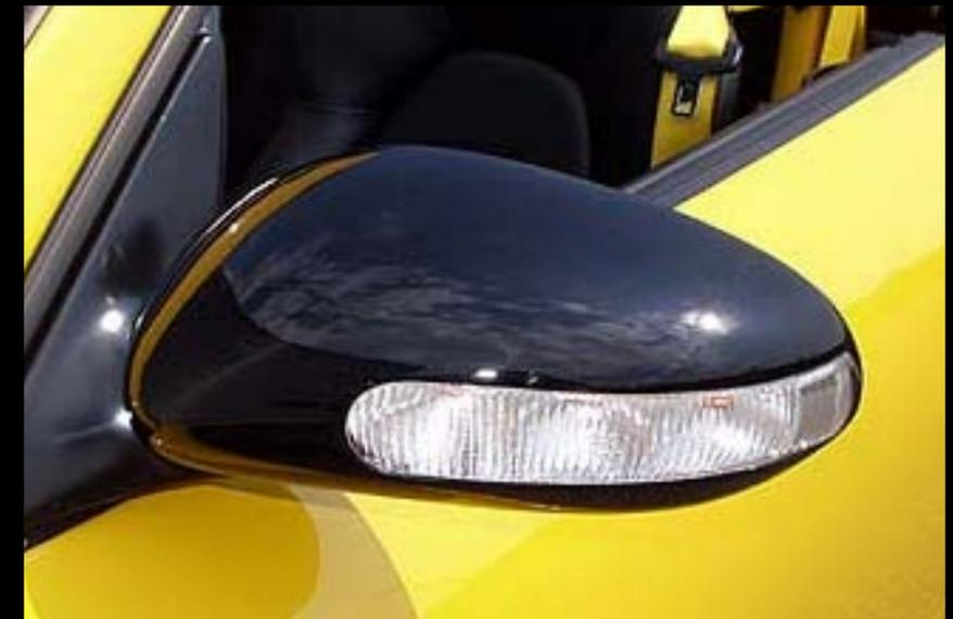
Rückspiegelschalen mit integriertem Blinker
